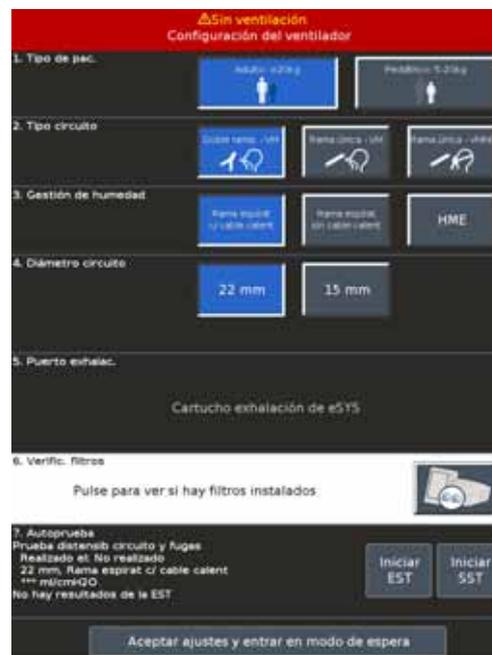
Figura 5-7: Pantalla de configuración para sistema con rama doble (adulto)
