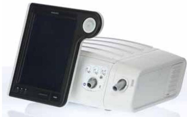
**Tipos y modos de ventilación.** El ventilador ofrece tres configuraciones de ventilación: invasiva de rama única (VM), no invasiva de rama única (VMNI) e invasiva de doble rama (VM). Cada una ofrece una gran variedad de modos.
