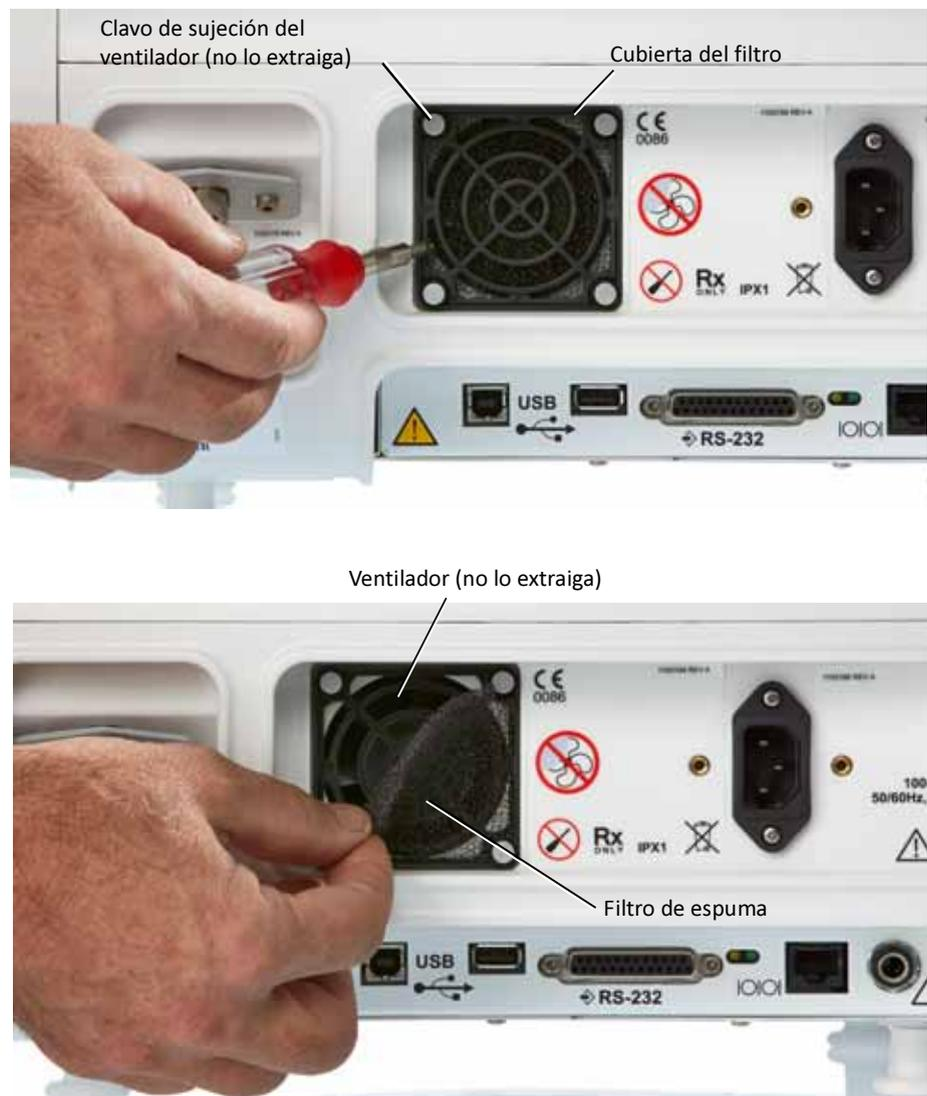
Figura 10-9: Sustitución del filtro del ventilador de refrigeración
