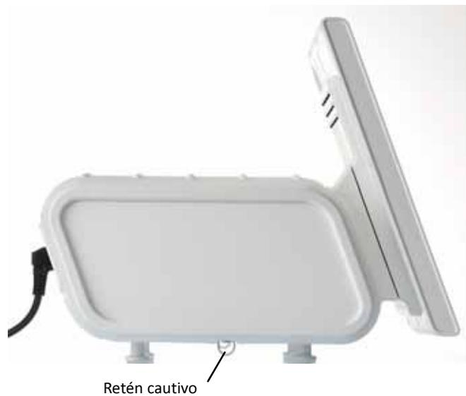
*Figura A-1: Retirada del panel lateral.*
