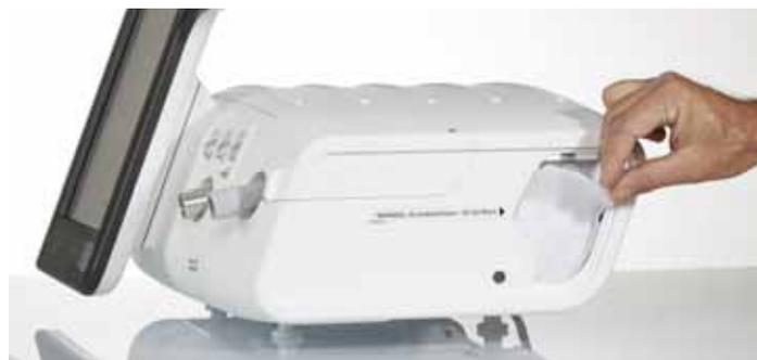
*Figura 10-8: Sustitución del filtro de la entrada de aire*
