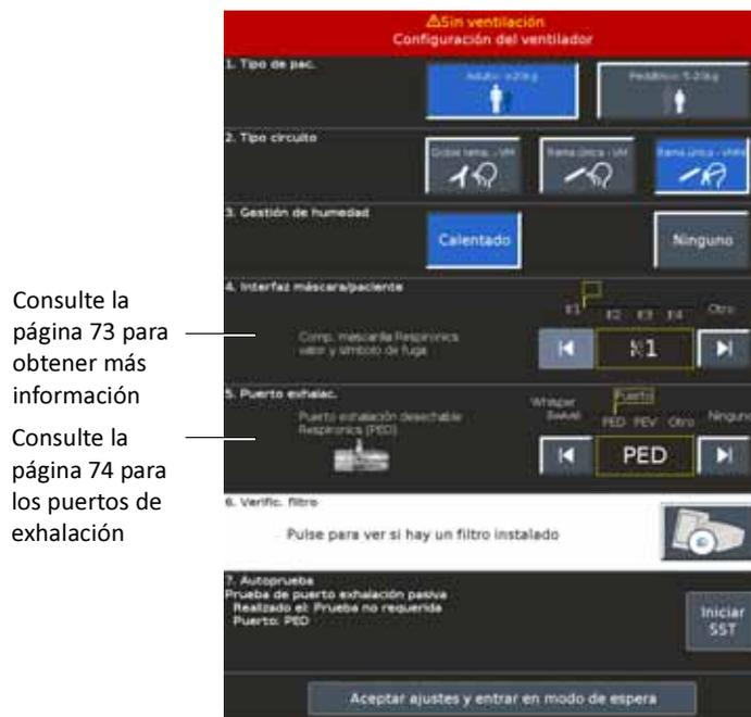
Figura 5-9: Pantalla de configuración para sistema no invasivo con rama única (adulto)
