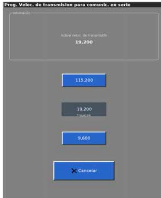
Figura E-9: Prog. Veloc. de transmisión para comunic. en serie
